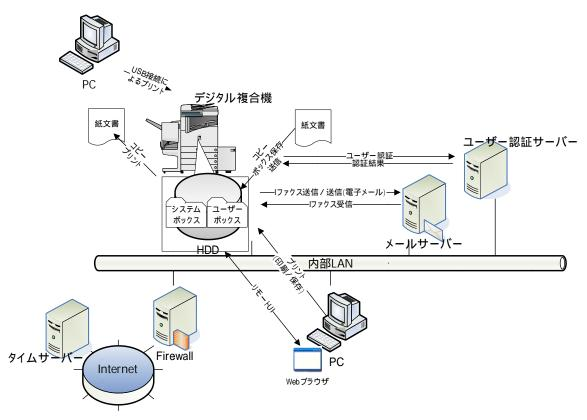
Figure1 に示すような想定設置使用環境では、デジタル複合機は内部 LAN によってメールサーバー、ユーザー認証サーバー、PC、Firewall に接続されており、Firewall によって Internet から内部 LAN への攻撃を防いでいる。デジタル複合機は、自身で読み込んだ電子文書を I ファクス送信や電子メール送信したり、Iファクスを受信したりするためにメールサーバーに接続する。また、PC を用いて電子文書をプリント、保存、Iファクスを利用することができ、Webブラウザ<sup>2</sup>をPC上にインストールすることでデジタル複合機をリ
