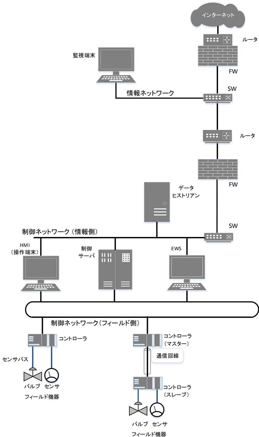
図 3-10 その他の制御システム構成図(分類 2:FW+ルータ)
