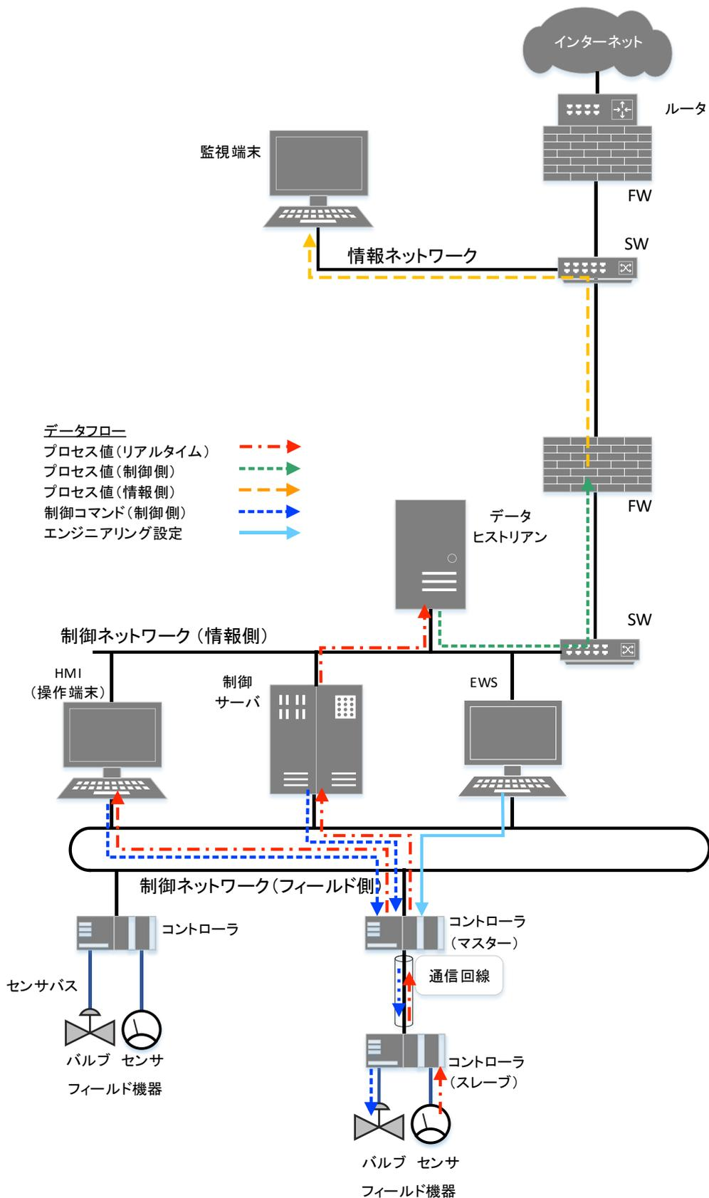
図 3-16 その他の制御システム(分類 2:FW+ルータ)におけるデータフローの例
