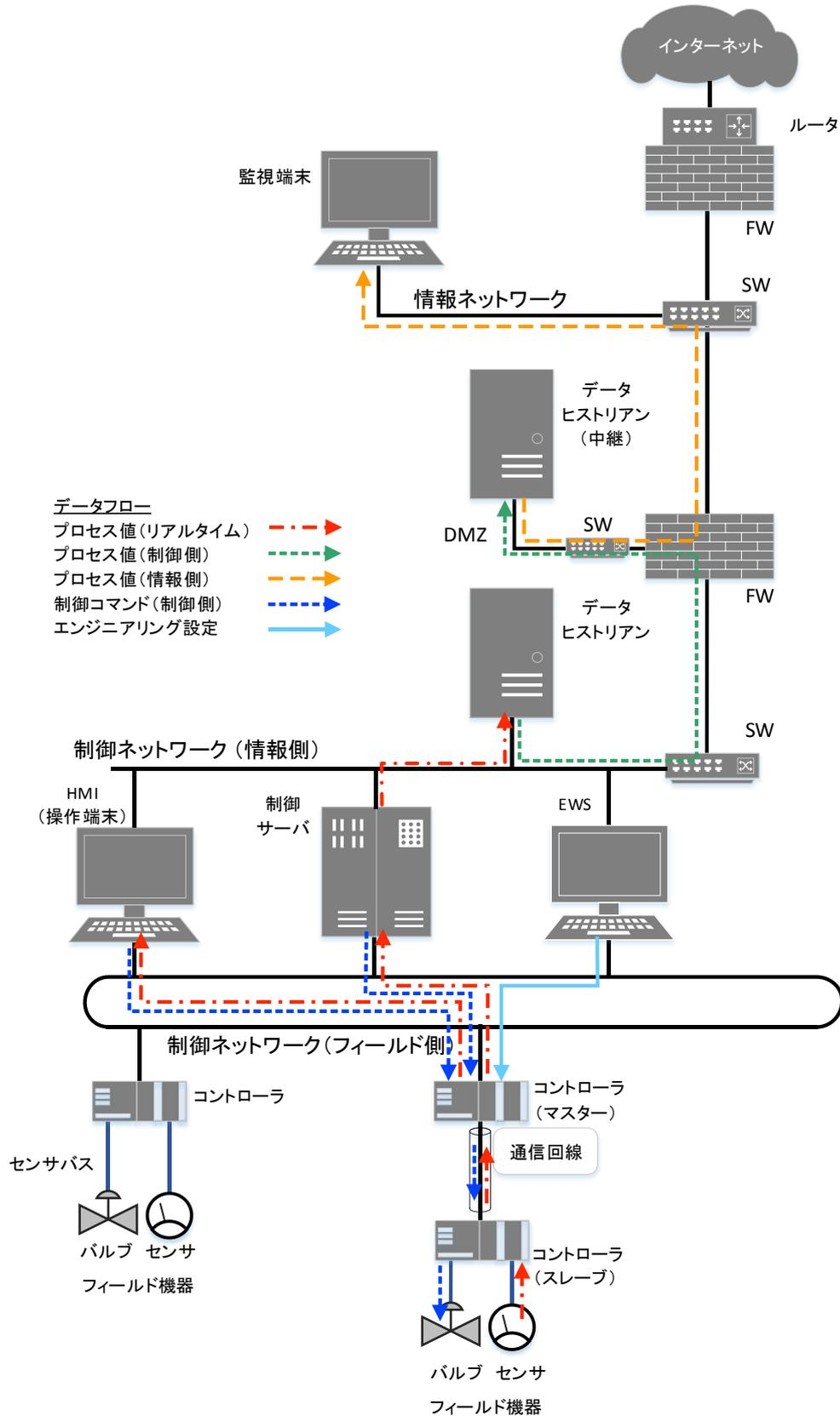
図 3-14 典型的な制御システム (分類 3:DMZ)におけるデータフローの例
