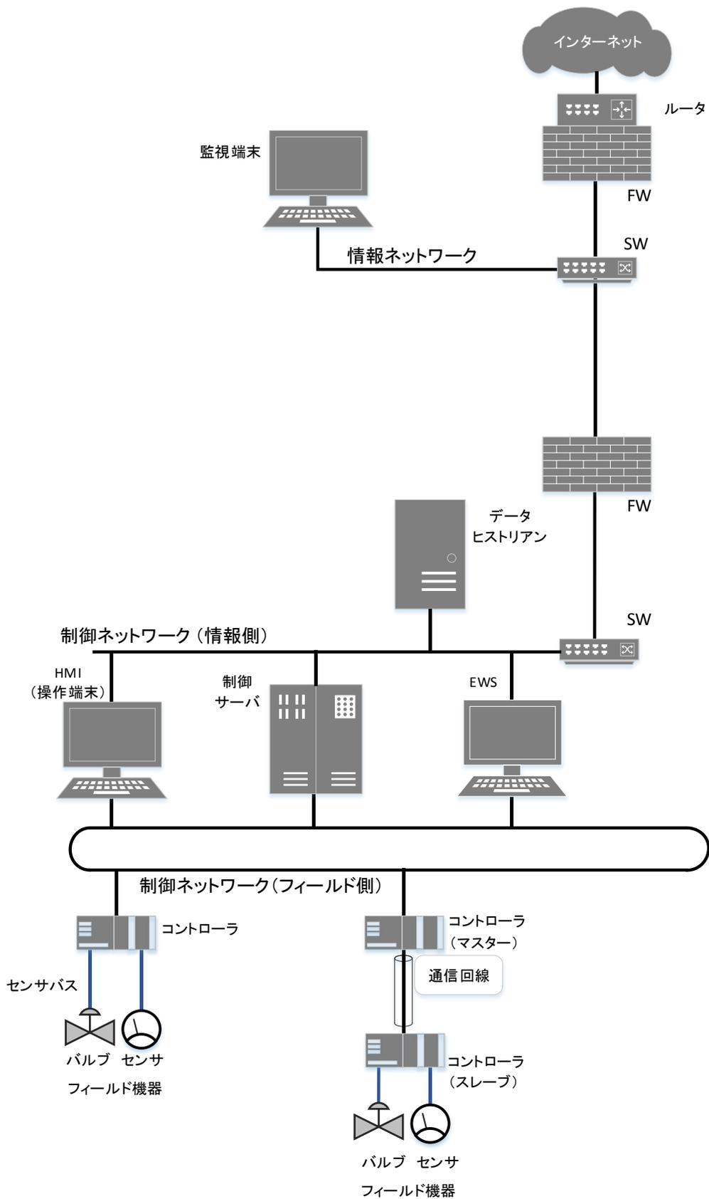
図 3-9 その他の制御システム構成図(分類 1:FW)
