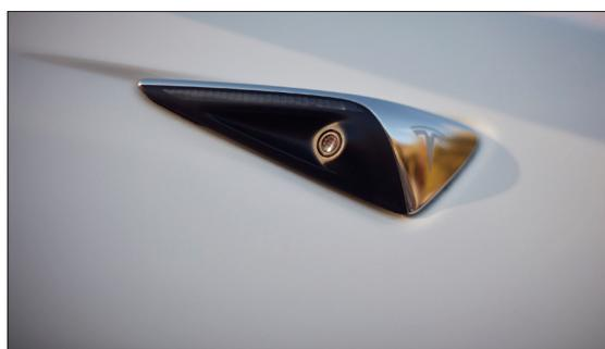
Teslaがオプションで提供する、レーダーと8台のカメラ、12個の超音波センサ。得られた情報をリアルタイムに処理できる車載コンピュータと、各所に設置されたこれらのカメラやセンサによって、車の全周をカバーする。将来の自動運転を見据えて、段階的にソフトウェアがアップデートされる予定とのこと。(写真提供：Tesla)
