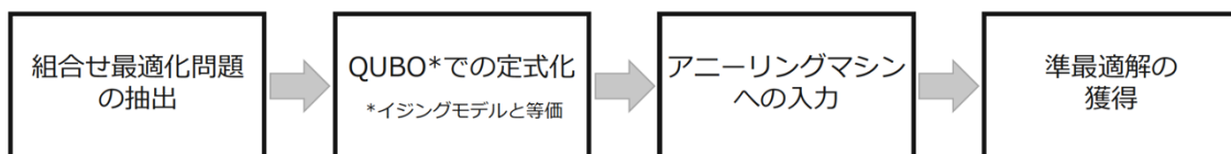
図 1：アニーリングマシンによる組合せ最適化問題の求解手順
