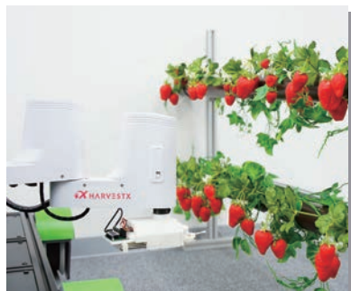
植物工場のための自動授粉・収穫ロボットシステム
