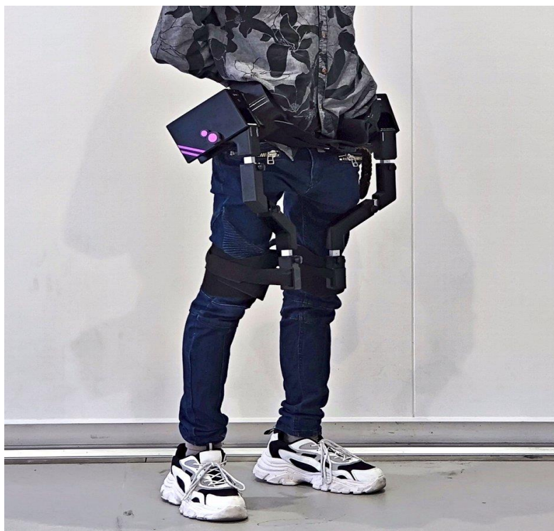
図 1: 本プロジェクトで開発したアシストスーツ「Mechanical Suits」
