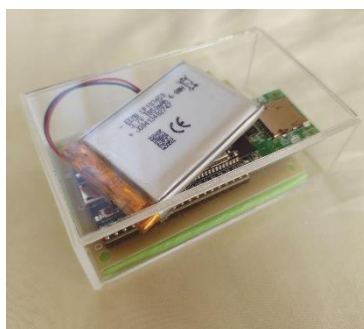
図 3:選手のベスト等に装着可能な小型データ受信デバイス
