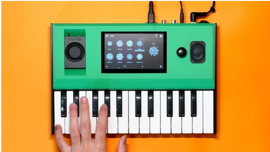
図 1：共感覚シンセサイザーの外観 鍵盤、ディスプレイ、スピーカーを統合している。
