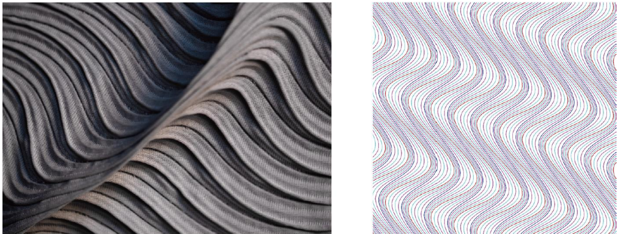
図 4. ヒンジによってエッジが立った様子(左)とヒンジを生む襷の配置パターン(右)
