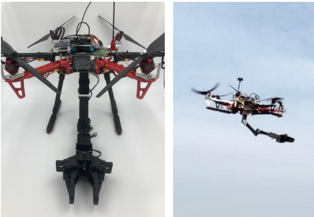
図 6 : 非平面ロータ配置かつロボットアームにより飛行中に重心が変化するドローン
