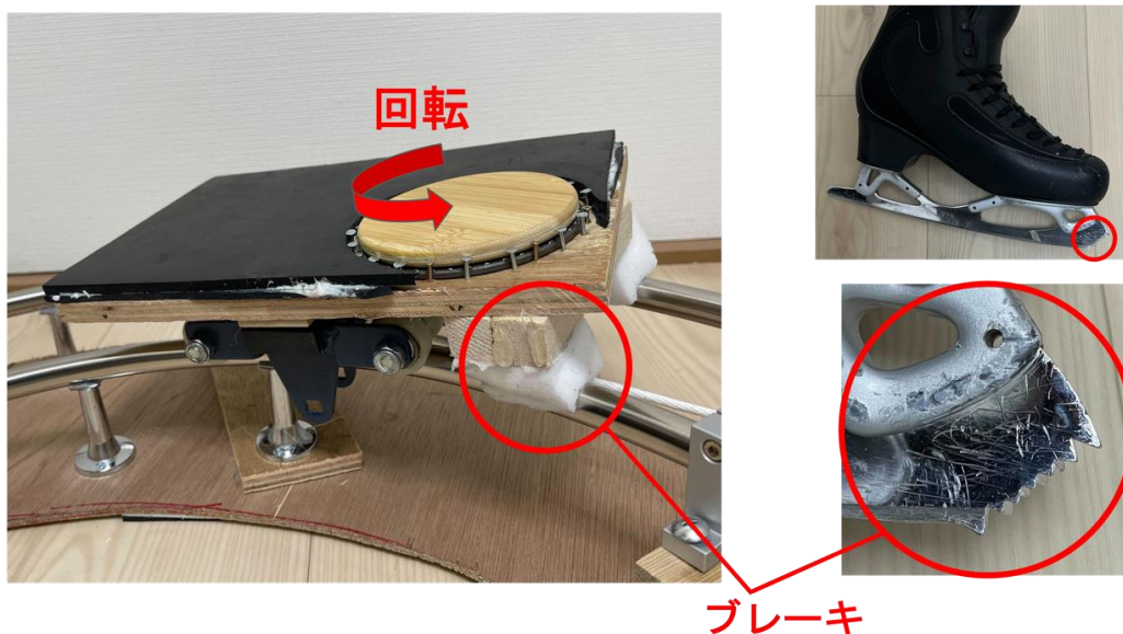
図 2: Skate Jump Board の台車の詳細構造
