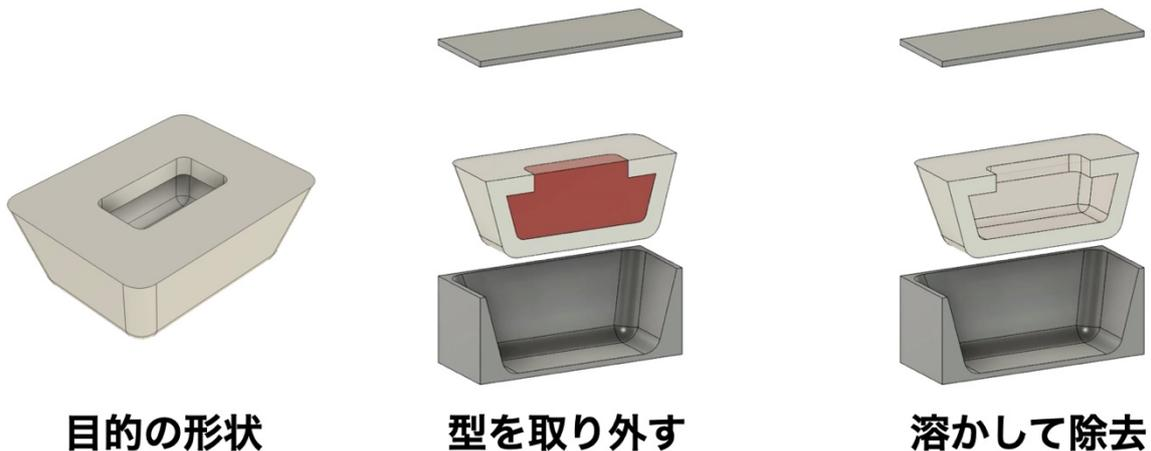
図 2: 抜かない型のイメージ図、赤い箇所が抜かない型である
