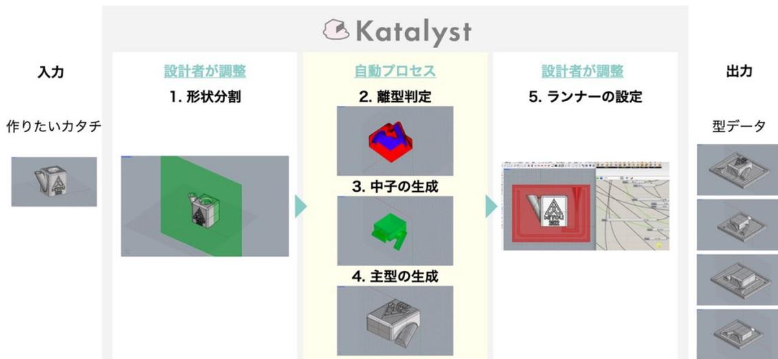
図 3: Katalyst による型設計の概要
