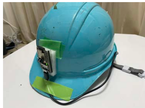
図 5: ヘルメットに装着した撮影デバイス
