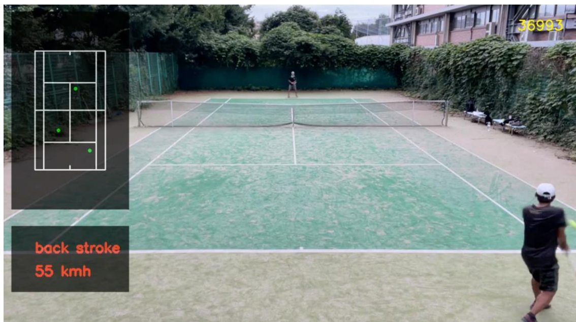
図 2：コート上のバウンド位置とショットの種類、ショットの速度を画面中に表示
