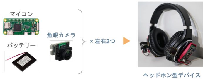
図 2: 装着者の姿勢推定を実現するヘッドホン型デバイス
