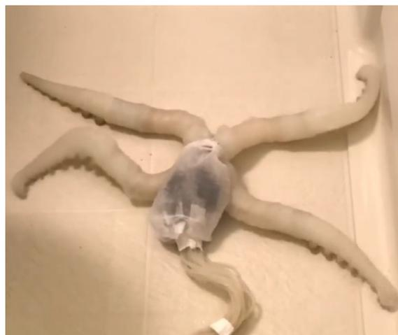
図 4: 開発したタコ型ソフトロボット
