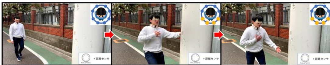
図 6：危険アラート（電柱にぶつかる前に振動で危険察知）
