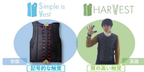
図 1:開発した2つのベスト型デバイス
