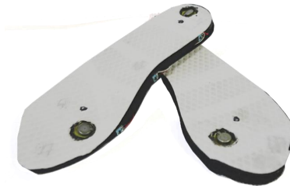
図 1. インソール型デバイス Vibsole
