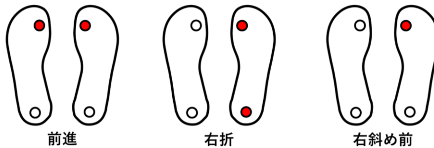
図 3. 方向提示の振動パターン例（赤い部分が振動する）
