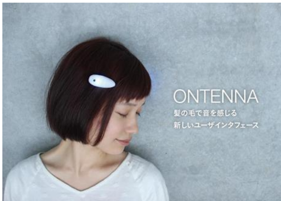
図 1 髪の毛で音を感じる新しいユーザインタフェース「ONTENNA」
