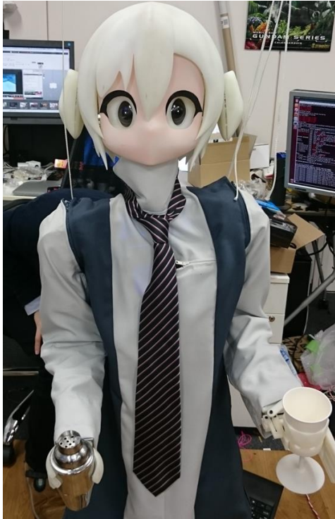
図 1 バーテンダーロボットの全体像
