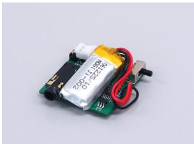
図 3 Bluetooth 接続型ハードウェア 寸法: 32mm(W) x 32mm(D) x 12mm(H)
