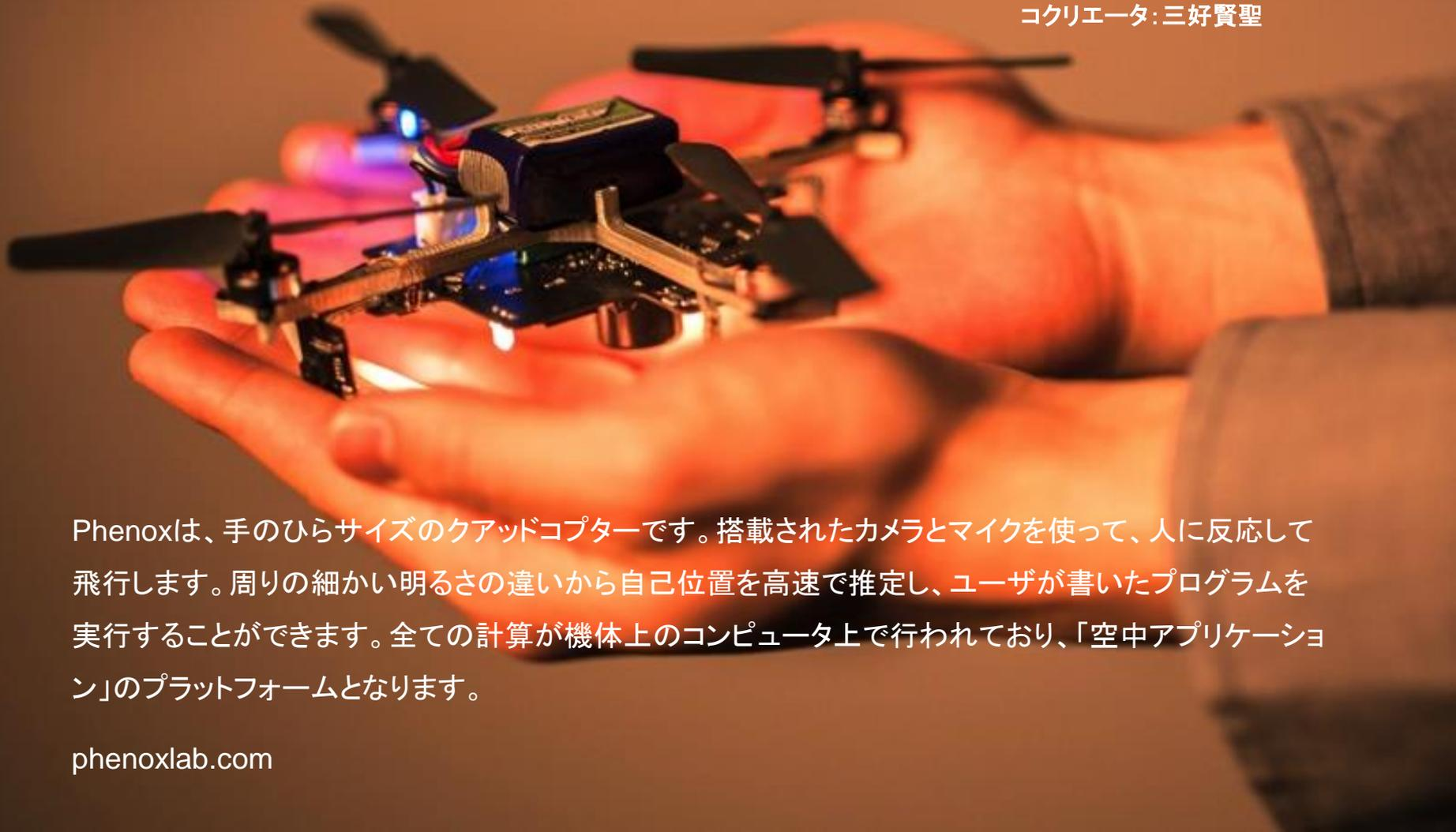
Phenoxは、手のひらサイズのクアッドコプターです。搭載されたカメラとマイクを使って、人に反応して飛行します。周りの細かい明るさの違いから自己位置を高速で推定し、ユーザが書いたプログラムを実行することができます。全ての計算が機体上のコンピュータ上で行われており、「空中アプリケーション」のプラットフォームとなります。
