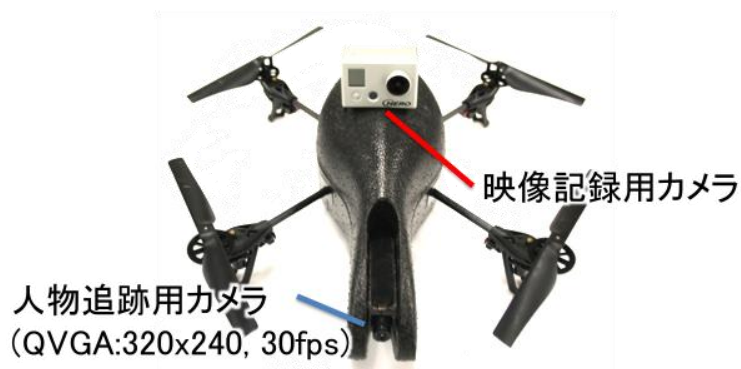
図 2. 撮影用ヘリコプターとして採用した AR. Drone
