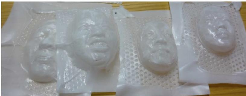
図2:3D スキャナー、3Dプリンタで作成した顔スクリーン
