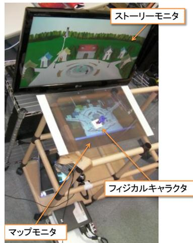
図 2 テーブルトップインタフェースプロトタイプ外観
