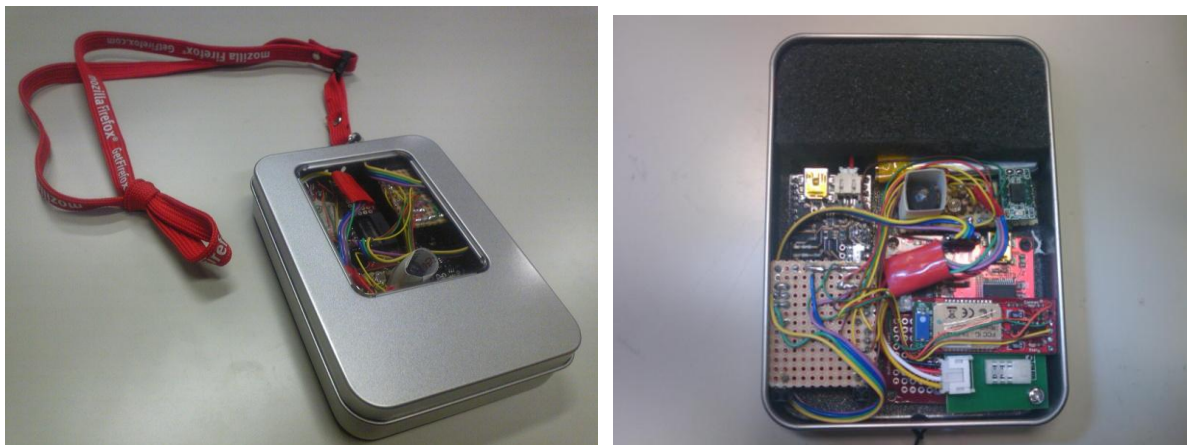
図 3 センシングアクセサリの内部構造
