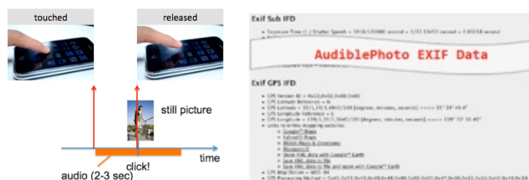
図 2. 開発プラットフォーム(左), と EXIF タグにおける AudiblePhoto の EXIF データの組み込み。
