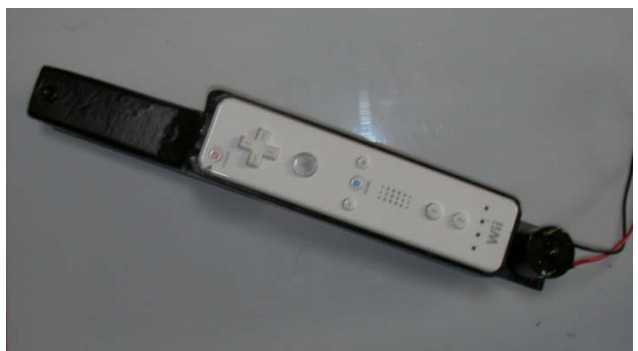
図3. 4 Wii リモコン用フォースフィードバック機構
