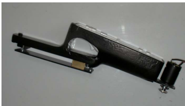
図3. 4 Wii リモコン用フォースフィードバック機構
