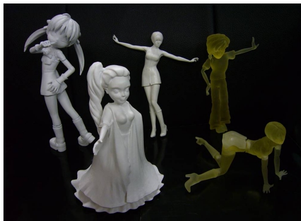
図 6 本ソフトウェアを使用し、造形出力したフィギュア
