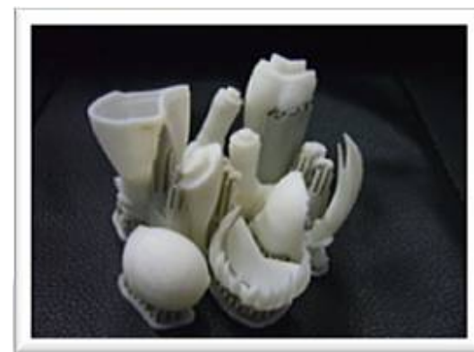
図1 造型出力したフィギュア。シリコン型の複製が可能なようにパーツ分割されている。
