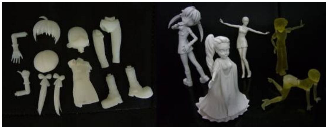
図3 市販の3DCGモデルデータから本ソフトにより加工・編集し、フィギュア造型出力したもの
