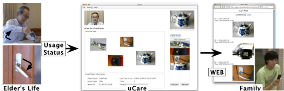
図9: uCare の動作概要図
