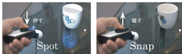
図3: uAssociator Camera によるセンサノードとモノの関連づけ動作 Spot & Snap
