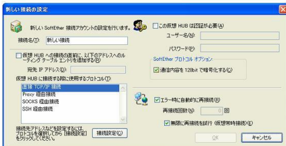
図 7 仮想HUBと仮想クライアントの接続方法の設定
