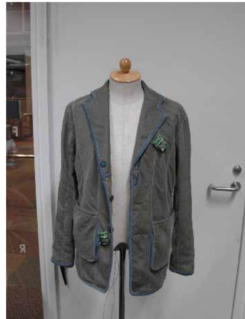
図2. 試作した導電性素材を用いた衣服
