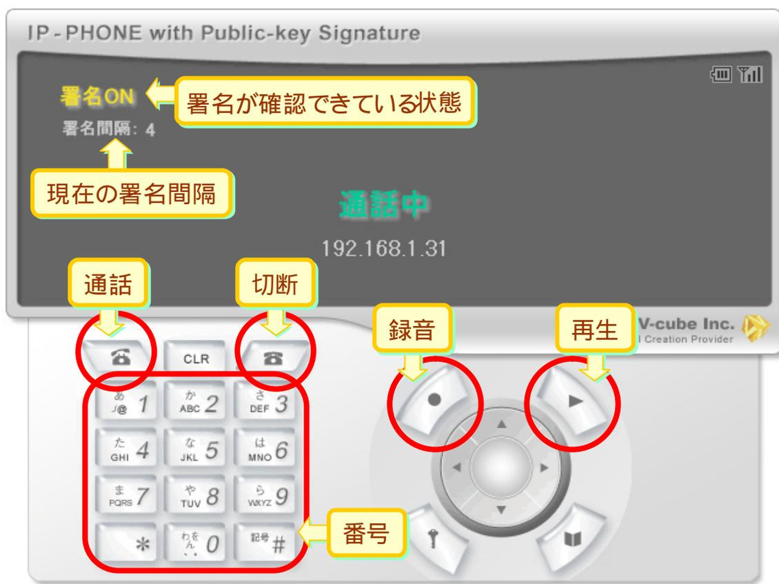
図 1: IP 電話のユーザインタフェース
