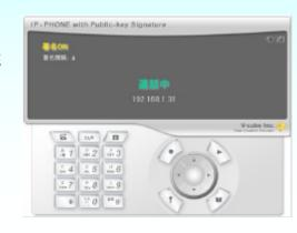
認証局により認証された 公開鍵を所有していれば、 通話データは認証サーバ を介さずに直接相手の端 末に送信されるため、 サーバを介して記録する ことにより通話内容の証 明を行うシステムと比較し て安価にサービスを提供 可能。
