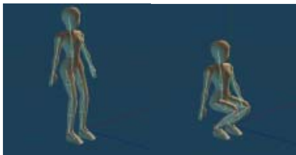
図7 FlexIKの動作結果 左) 足を固定化した状態 右) 腰にあるポイントを移動操作した後の姿勢
