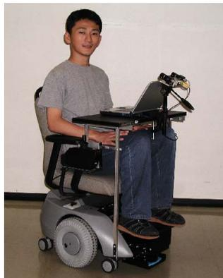
図 22: 視線操縦型車いす
