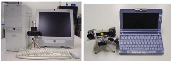
図 11: システム実装例 (左: デスクトップ PC+IEEE 高速ステレオカメラ, 右: ノート PC+NTSC カメラ)
