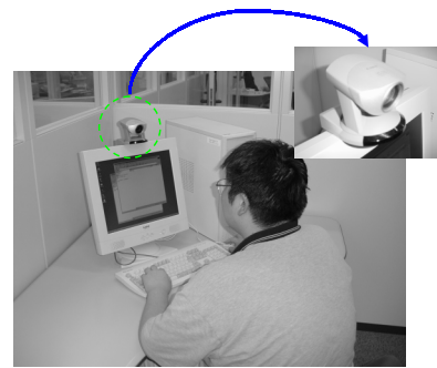
図 4: 端末前に設置されたカメラロボット
