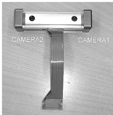
図 3：小型ステレオカメラ（携帯エージェントシステムのディスプレイ上部に取付けて利用している。CPU に PentiumIII,850MHz を使った場合、320x240 ピクセルのステレオ画像から毎秒 5 ～ 6 回の距離画像の算出が可能。）
