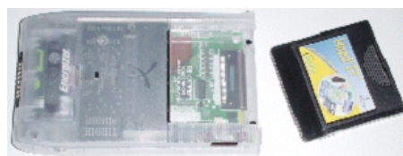
図 1-2 PDA（左: Handspring™ Visor™）に着脱可能なスマートタグ読み取り装置（右: Inside Technologies Hand'IT）
