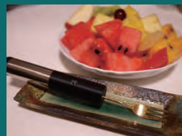
電気刺激で味覚を変える フォーク型デバイス
