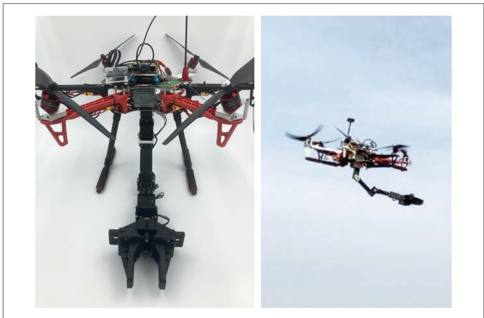
図7：非平面ローター配置かつロボットアームにより飛行中に重心が変化するドローン
