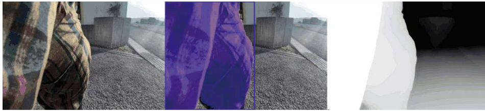
図3：人追従の様子。「ついてきて」などの指示を出すと、GO_TO("person")というコマンドに変換され、元画像（左）から人の検出・セグメンテーション（中）と深度推定（右）を実行する
