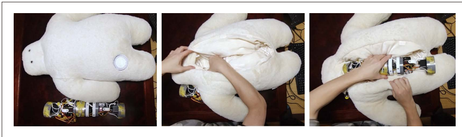
図8：人型のぬいぐるみロボットの組み立て
