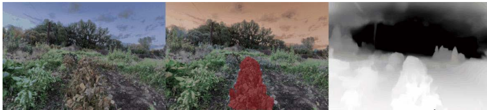
図4：作物列追従の様子。「この作物列を進んで」などの指示を出すと、GO_ALONG("crop row")というコマンドに変換され、作物列の検出・セグメンテーションと深度推定を実行する
