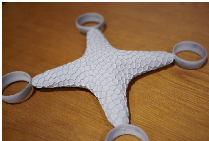
図 5 Implicit モデリングで実現したラティスを付与したドローン筐体の印刷結果
