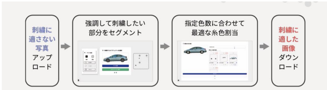
図2 刺繍向け画像への変換フロー
