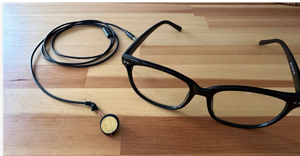
図 1 鼻軟骨マイクロフォン
