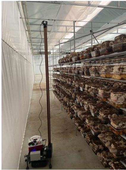
図 1 : ほ場を自動で走行して動画を撮影するロボット
