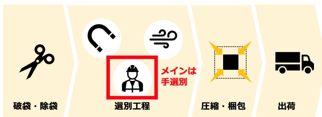
図 1. 中間処理施設における出荷までの工程
