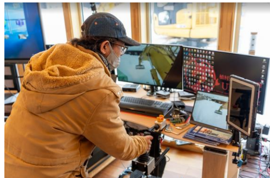
図8 Shunkei VTX を用いた遠隔操縦
