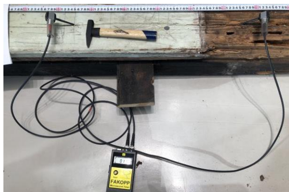
図 5. 最新の弾性波を用いた準非破壊検査
